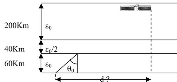
Trouver la distance terrestre «d» entre l'émetteur et le récepteur du satellite avec un angle d'incidence au départ égale à  $30^\circ$ .
