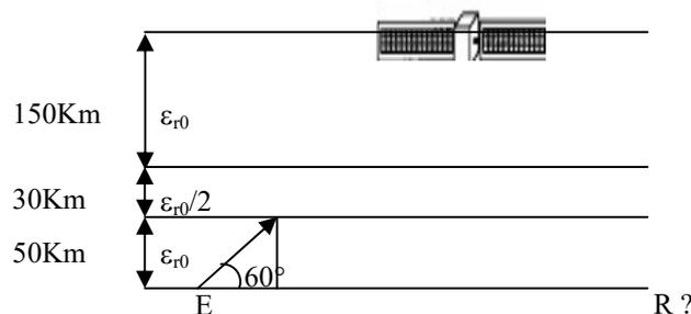
1/- Pour le schéma ci-dessus, on demande de calculer la distance «d» entre l'émetteur et le récepteur d'une station terrienne en utilisant comme relais passif un satellite placé sur une orbite située à une hauteur de 230Km par rapport à la terre.
