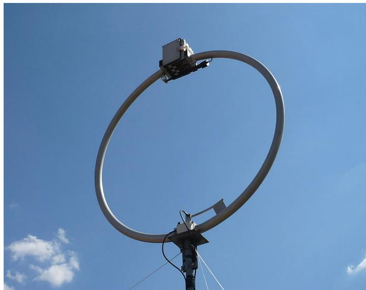
**Fig. 5.6 : Antenne cadre magnétique**
