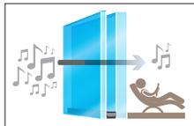
**Thermobel Stratobel** – Vitrage isolant intégrant 1 ou 2 verres feuilletés dans la composition, pour des performances acoustiques avancées
