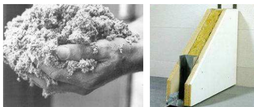
A gauche : cellulose en vrac ; à droite : panneau à base de cellulose et de lin Source : www.turrian-jeanjacques.ch , et www.isorex.com
