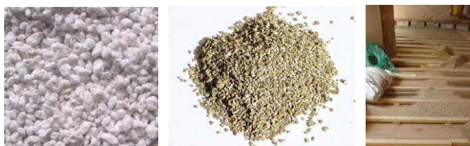
A gauche : perlite ; au centre: vermiculite, à droite : exemple de mise en œuvre Source : http://www.travellersgarden.com et http://aggie-horticulture.tamu.edu
