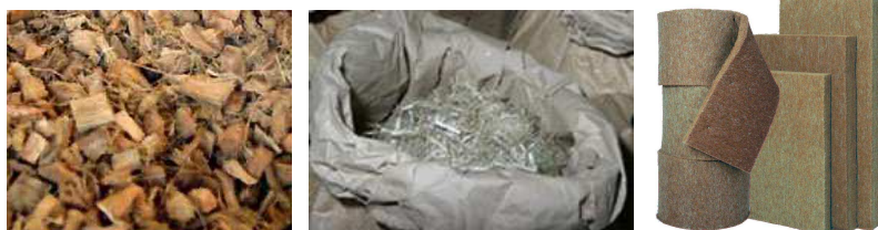
A gauche : noix de coco, à droite : chènevotte de chanvre (matériau brut) et laine de chanvre Source : http://blog.environmental.info/?cat=32
