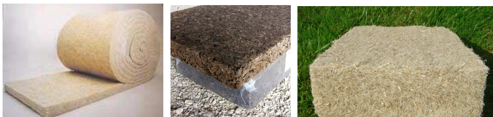
Exemples d'isolants végétaux - de haut en bas et de gauche à droite : cellulose / laine de chanvre en rouleaux / panneau de liège expansé / laine d'herbe
